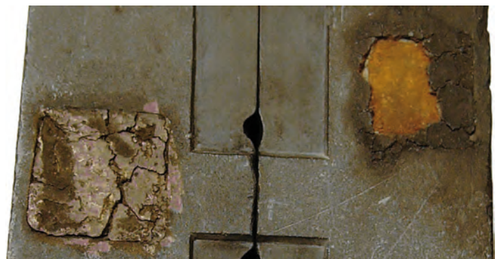
rechts: Zum Vergleich eine fast unversehrte Abdeckung der Bolzen an einer Artillerieform
