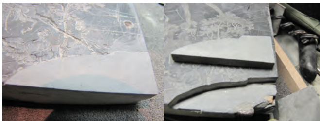
oben (links und rechts): Fehlstelle für Gravur vorbereitet, Schiefer eingesetzt und plangeschliffen
