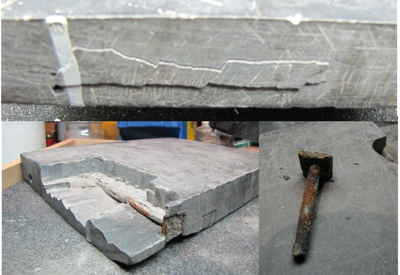
oben: Scherben mit Überstand, darunter abgefräste Stelle, entfernte Gewindestange
